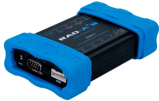
RAD-A2B将ADI公司的A2B技术与两个CAN / CAN FD收发器和一路LIN通道相结合，使得一个带有时间戳的日志中包含不同的网络报文。RAD-A2B包含一路用于A2B接收监控的通道和一路可以充当仿真器节点通道。
