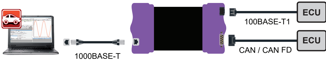
使用RAD-Jupiter作为CAN / CAN FD与以太网之间的网关
